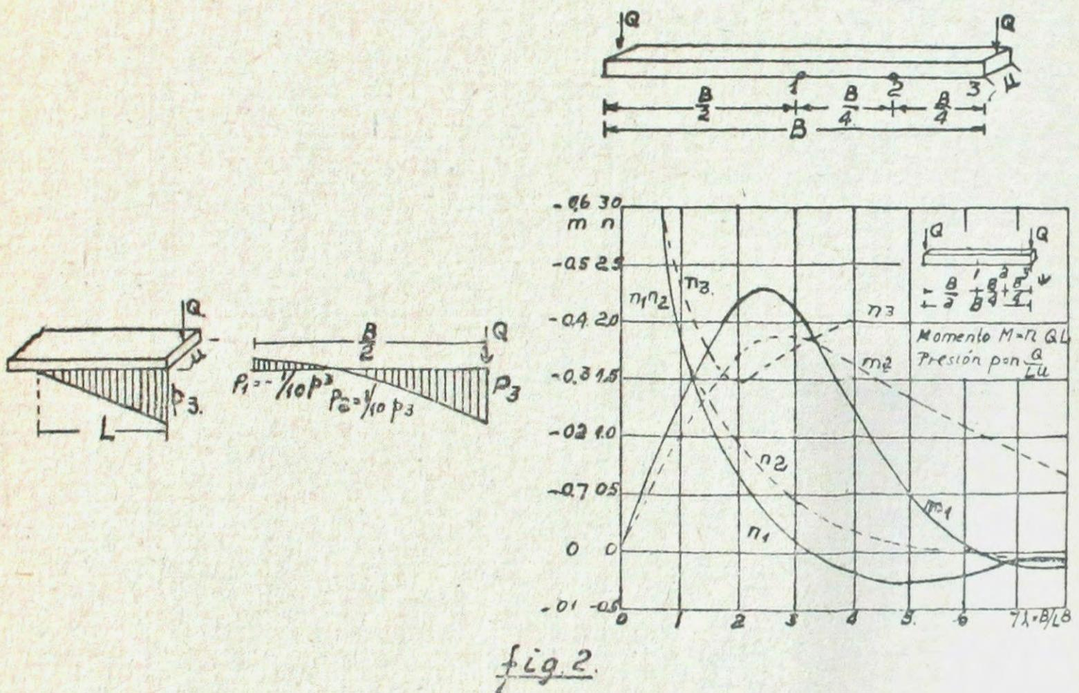
Caben aquí dos soluciones: 1.º Considerar sólo el momento de inercia de la zapata de fundación y su nervio, que cuando se trata de grandes edificios abarca generalmente todo el subterráneo y por lo tanto es de apreciable rigidez, despreciando en consecuencia las rigideces de los elementos superiores y su contribución a la resistencia; y
